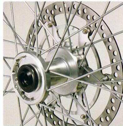
Particolare del mozzo anteriore (ricavato dal pieno), con i nuovi parapolvere.
